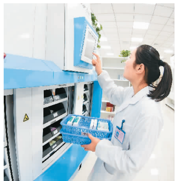
在江苏连云港市第一人民医院智慧药房，工作人员正查看智能药物存储管理分发系统运行情况。
