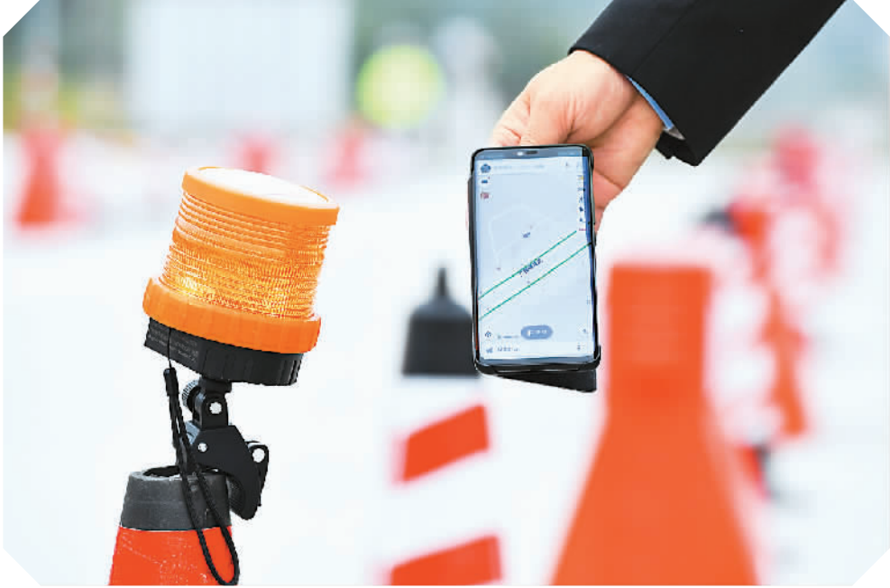
高德地图推出应用物联网化改造的“智慧锥桶”，在接入其地图App数据平台后，可以实现道路施工、事故和封闭管制等信息的实时采集和发布，提升用户出行效率和安全水平。图为今年1月，一个设置在广佛肇高速公路鼎湖休息区的“智慧锥桶”发布的道路施工信息已经被上载到地图App。 新华社记者刘大伟摄
