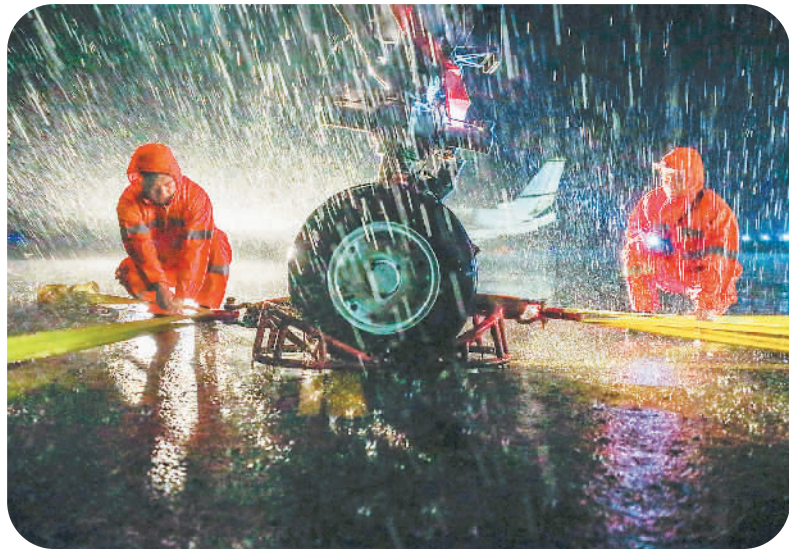
8月10日晚间，江苏省扬州泰州国际机场，春秋航空地勤人员对驻场飞机进行固定，确保飞机不被台风吹移。
