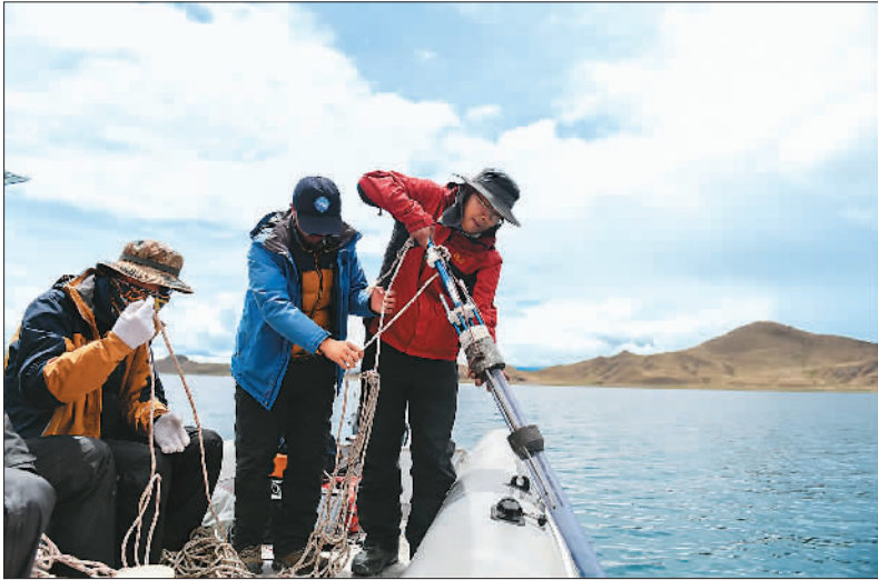
第二次青藏高原综合科考目前正在对位于西藏山南市浪卡子县境内的羊卓雍错进行深度测量，并测算水量。这是中国科学家首次对该湖进行全面的水深等深线测量。羊卓雍错简称羊湖，距拉萨不到100公里，其自然景色优美，是西藏的热门旅游景点之一。图为7月22日，科考队员在投放重力钻，准备钻取湖泊沉积岩芯。新华社记者 晋美多吉摄
