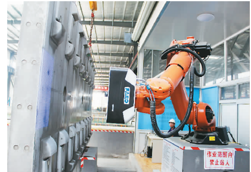
图为智能机器人在对轨道板进行检测。
