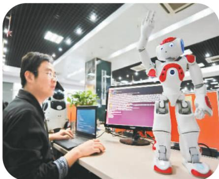
科大讯飞智能机器人工程师对机器人“小柔”进行声学视觉等方面的系统集成。
