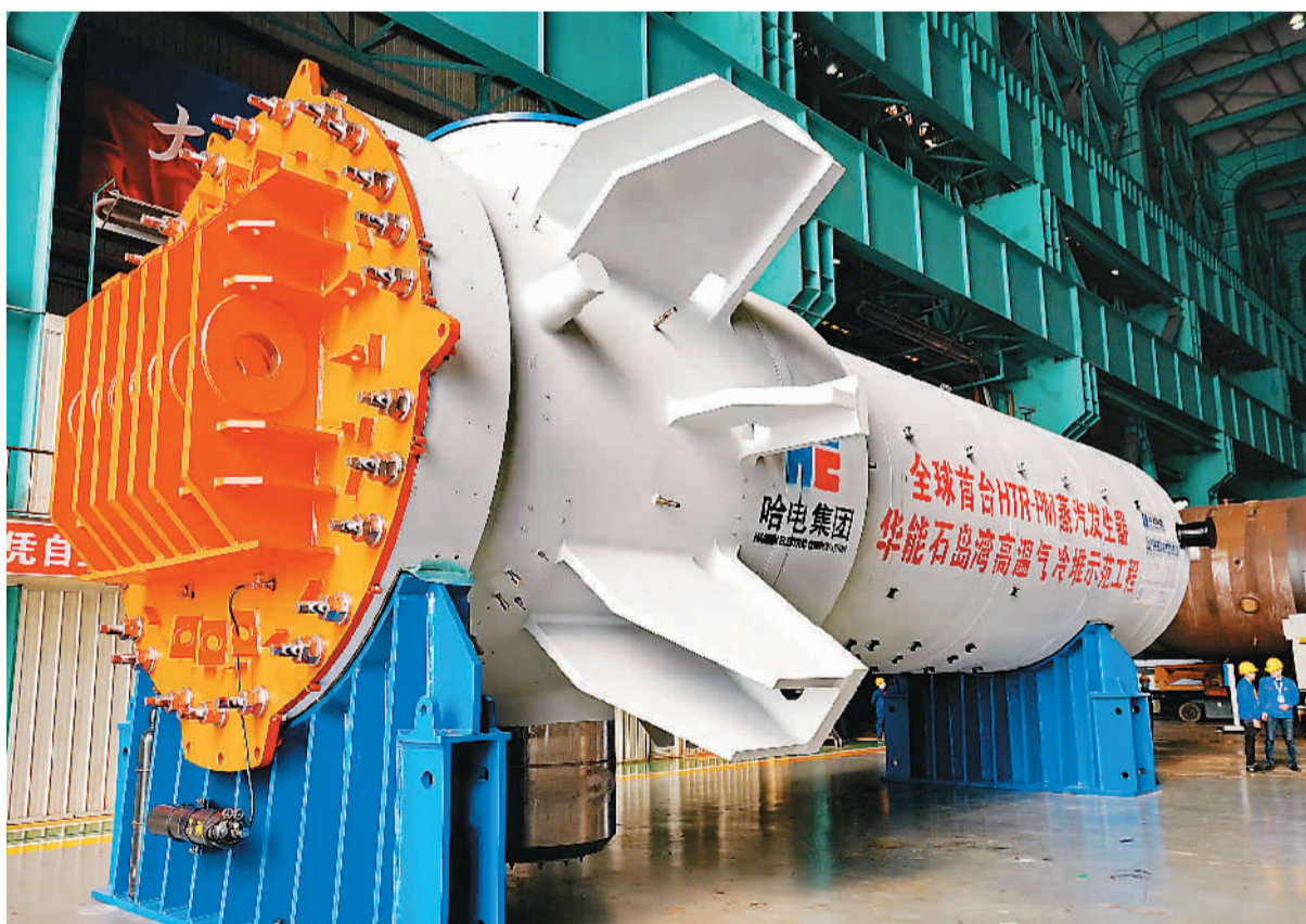
10月31日，由哈电重装备研制的全球首台球床模块式高温气冷堆蒸汽发生器在河北秦皇岛通过验收。 新华社记者 杨世尧摄
