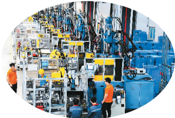
图为江苏省太仓市骏伟塑胶制品有限公司注塑车间内，50余台机械手正在自动化流水线上装配汽车门锁塑胶件。
