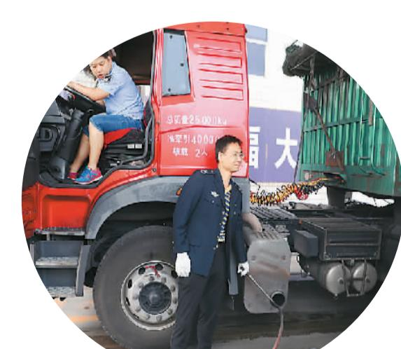
去年以来，石家庄市加大对机动车尾气超标排放的治理力度，依靠科技手段治理机动车尾气污染。图为石家庄平山县机动车环保检测站，检测人员正在用烟度计检测平台对机动车进行环保检测。
