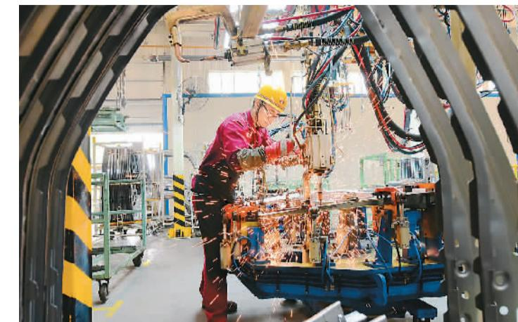
4月30日，国家统计局、中国物流与采购联合会联合发布数据，4月份，中国制造业采购经理指数（PMI）为51.4%，制造业继续保持稳步增长的发展态势。图为工人在江淮汽车山东分公司焊接车间内制造生产轻卡汽车结构件。
