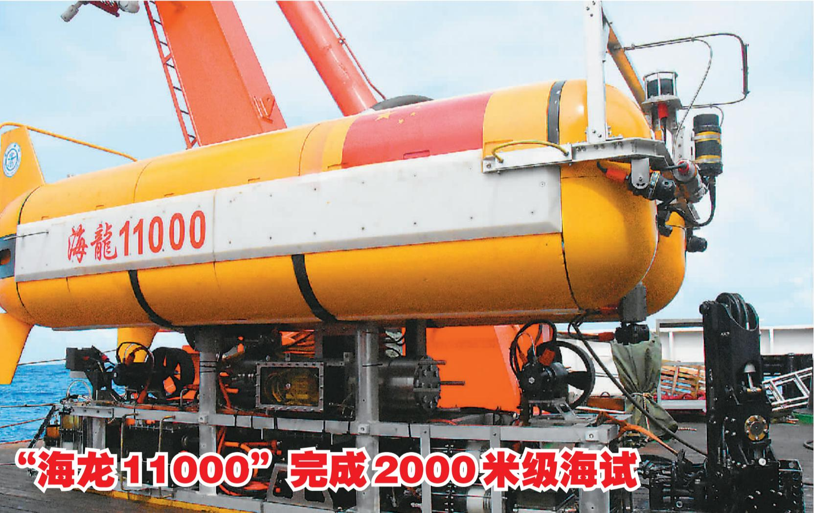
4月1日,正在西太平洋执行2018年综合海试任务的“大洋一号”科考船,再次完成由中国自主研发的“海龙11000”万米级无人潜水器(如图)海试,潜深2605米。此前的3月30日,该潜水器完成首次海试,潜深410米。
