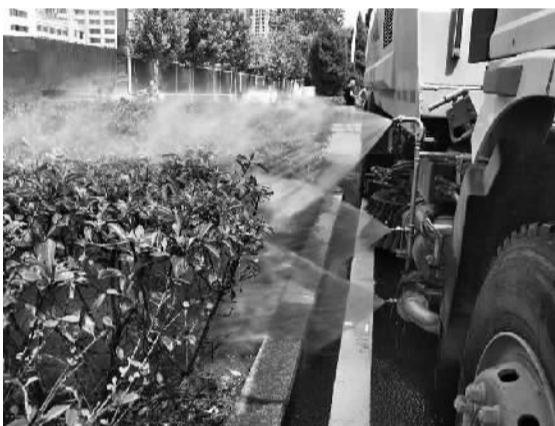
商丘市环卫多功能洗扫车在道路上冲洗作业
