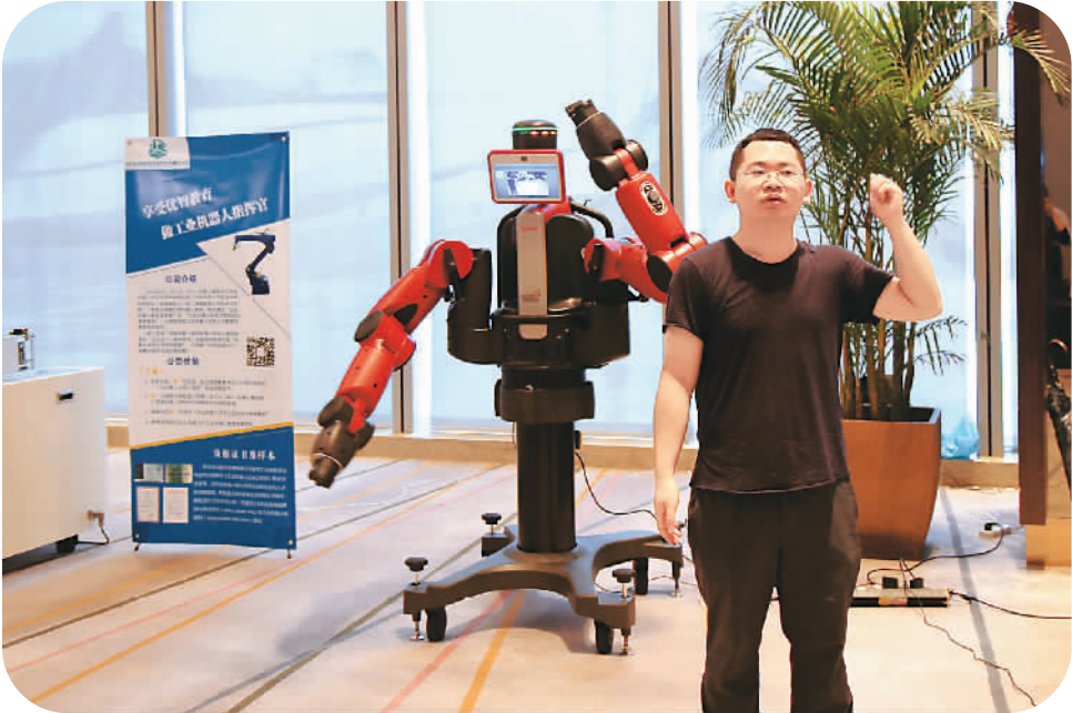
图为瑞森可生产的协作机器人能模仿人的动作，可随意切换其工作任务与生产线上所负责的工序。
