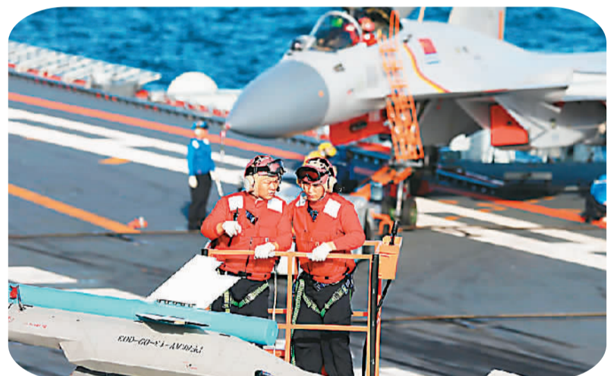
▲ 工作人员在对飞行后的歼-15舰载战斗机进行状态检查。 新华社记者 曾涛摄
