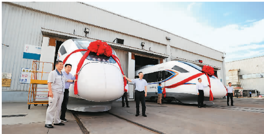
CRH6F型城际动车组是中车青岛四方机车车辆股份有限公司研制并拥有完全自主知识产权的我国首款时速160公里城际动车组。5月23日,中车四方将首批两列CRH6F型城际动车组交付给宁波市政府,近期将在宁波和余姚之间上线运行。 新华社发
