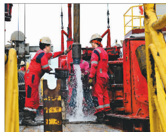
2月21日,由中国科学家主导的第三次南海大洋钻探顺利完成首个钻孔任务,为即将开展的基底岩石钻探奠定了良好基础。图为钻探工人从海里“拔出”钻杆。 新华社记者 张建松摄
