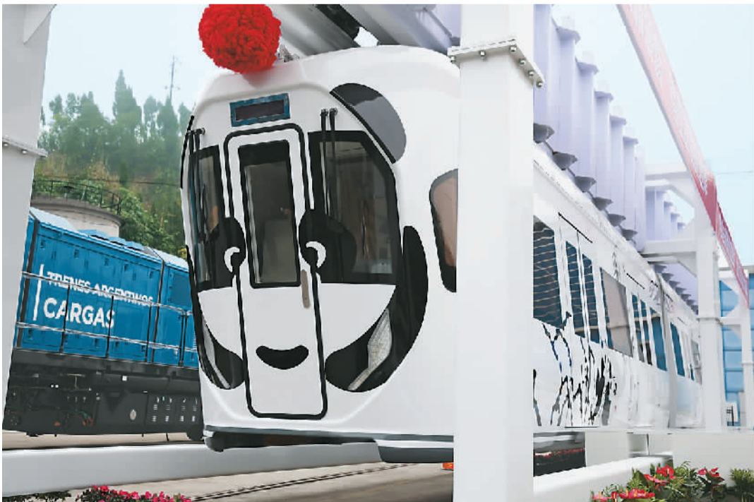
12月8日，中国首列商品化无人驾驶新能源空铁在中车资阳机车有限公司竣工下线。空铁外形模拟“熊猫”，时速最高可达65公里。在动力方面，列车采用了大容量动力电池充电控制技术，通过实现高倍率放电，提高列车启动加速性能及对极端环境的适应性，同时能将400千瓦的电控制功率全部用于动力电池快速充电。
