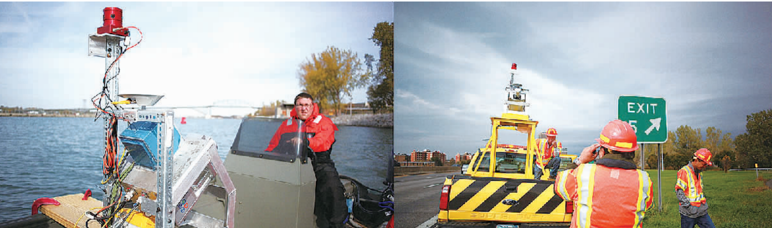
车载激光建模测量系统应用于美国五大湖生态调查和纽约高速公路勘测
