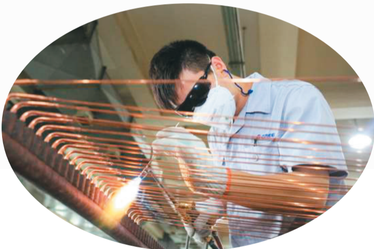
图为格力工作人员在焊接空调零部件。
