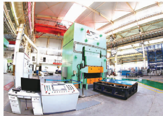
兰石集团自主研发研制的国内首台300MN多缸薄板液压机组
