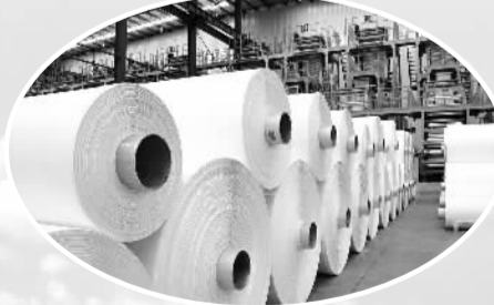
一块块石头打磨成石粉，加工成圆锭状后，被送入机器，而另一头出来的是一卷卷白花花石头纸。
