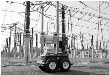
10月7日,在安徽省滁州市220千伏滁县变电站,机器人在对220千伏电力设备进行巡视。在国庆7天长假里,机器人对滁州电网管辖的220千伏变电站进行24x7全天候巡检,相当于代替400多名运维人员坚守在节日工作岗位上。宋卫星摄(人民图片)
