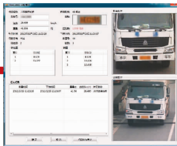
桥梁超载监控系统，可实时监控过往车辆是否超载 资料图片
