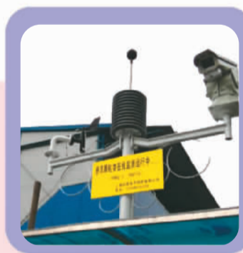
成都建设工地安电子眼，专逮PM2.5超标。 辜波摄
