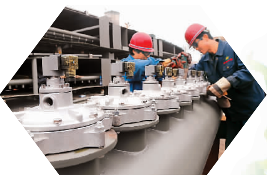
随着国家不断加大大气污染防治工作力度，河北省泊头市百余家环保除尘设备生产企业迎来了订单的大幅增长。图为2014年10月23日，在河北省泊头市一家环保公司，工作人员生产烟气脱硝脱硝除尘设备。傅新春摄（新华社发）
