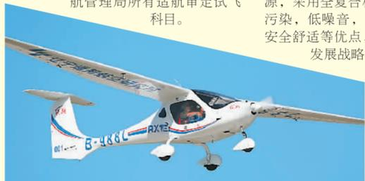
锐翔(RX1E)电动飞机是国内第一个具有自主知识产权的电动轻型运动飞机。该机以电动机为动力,锂电池为能源,采用全复合材料机体结构,具有零污染、低噪音、易操纵、运营成本低、安全舒适等优点,符合我国环境可持续发展战略,是环境友好型、能源节约型新能源飞机。该机性能优越,可广泛用于飞行员培训、观光旅游飞行等用途,将大量用于推进私人飞机在我国的普及和应用。
