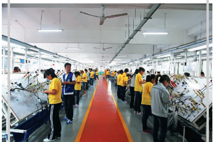
波尼陀元公司汽车线束生产线
