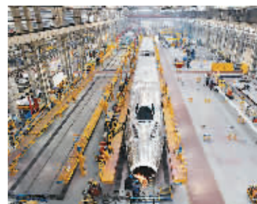
CRH380A高速动车组由中国南车四方股份公司自主研发。截至去年底,公司已成功交付146列该高速动车组。图为动车组在车间组装。 新华社记者 吴凯翔摄
