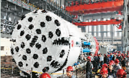
世界首台敞开放式无轨运输硬岩掘进机在中信重工成功试车。魏勤英 高德权摄
