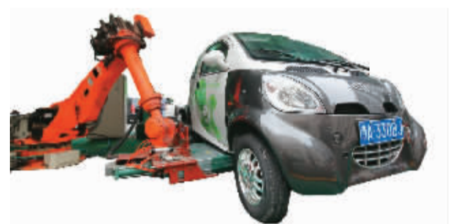
国家电网杭州古翠路充换电站的机器人在为电动汽车更换电池。 姚靖林摄 (新华社发)
