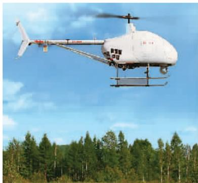
6月3日，我国自主研发的Z5型无人直升机在内蒙古大兴安岭林区根河航空护林站首航成功，这也是中型无人机首次应用于林业系统。该机搭载防火智能遥感探测系统，可实现探测数据的实时回传，为森林火灾的快速探测定位与综合指挥调度提供依据。图为Z5型无人直升机正在监测森林长势情况。本报记者 贺勇摄
