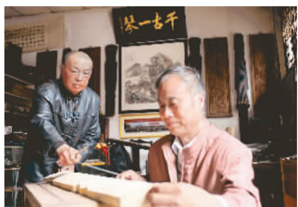
甘肃省天水市水帘山下是伏羲故里，善制伏羲式古琴——斫琴。其制作工序主要为选材、制胚、修面、掏槽、制底以及合琴等节，一把上好的伏羲古琴需要两三年才能制作完成。图为当地非物质文化遗产传承人王占云(左)和同伴一起给古琴拉墨线。
