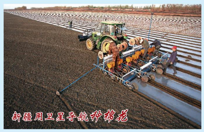
新疆生产建设兵团第二师二十九团日前率先在库尔勒地区应用 GPS 卫星定位导航,实现高精度播种棉花。据了解,应用 GPS 卫星定位导航系统后,该团的大型播种机可实现自动驾驶、高精度播种,1000米播行垂直误差不超过2厘米,一台装载该系统的 机车日播种棉花可达 300 亩。图为该团一名职工驾驶装有 GPS 卫星定位导航系统的大型播种机播种棉花。 杜炳勋摄(新华社发)
