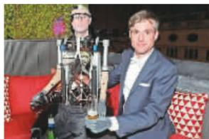
据英国《每日邮报》报道，英国机器人专家理查德·沃克和马修·戈登花费 100 万美元打造了一个名为“雷克斯 (Rex)”的仿生机械人。它身高 6 英尺（约合 1.83 米），是由来自世界各地研制成功的人造肢体和器官构成的。该仿生人的人工视网膜膜上被植入了芯片，并且内置了相机用以捕捉图像。
