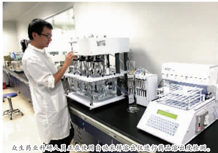
众生药业科研人员正在使用自动采样溶出仪进行药品溶出度检测。
