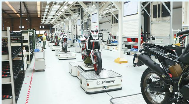
重庆鑫源摩托引入AGV智能生产平台，工作人员在该平台帮助下完成发动机组装、布管线、悬架装配、行驶系装配、附件装配等工序。
