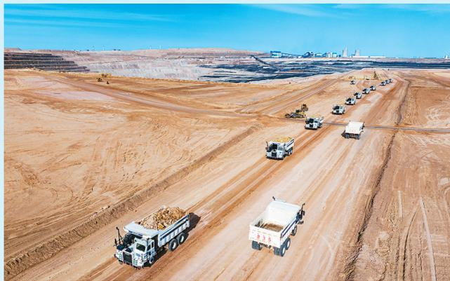
新疆准东经济技术开发区国家能源集团新疆能源有限责任公司准东露天煤矿，无人驾驶矿卡在运输土方。
