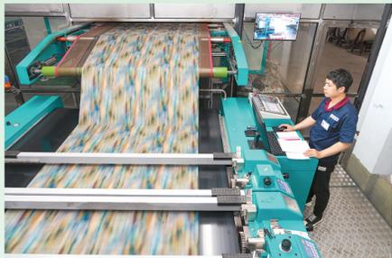
在浙江省绍兴市柯桥区的印染企业，工人在数码印花生产线上赶制订单。数码印花在绿色环保方面相较于传统印花具有明显优势，生产过程中无废染液色浆排放，降低了污染。
