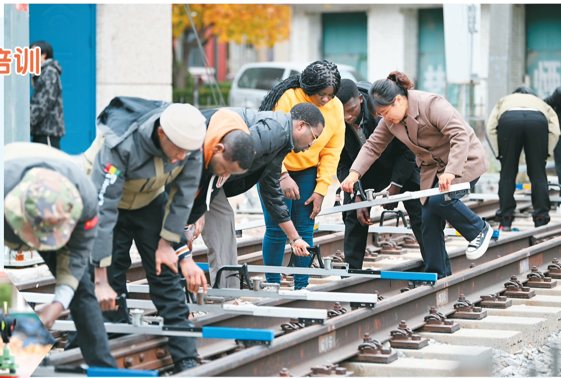
▲在天津铁道职业技术学院，老师指导几内亚学员使用铁路轨距尺。 ▲来自几内亚的学员在学习使用测距仪器。
