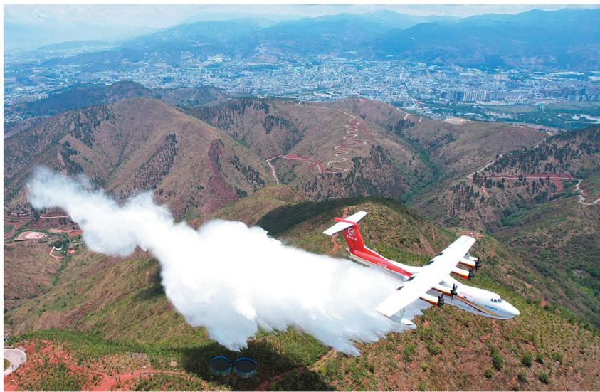
大型灭火/水上救援水陆两栖飞机“鲲龙”AG600在四川西昌市进行典型灭火场景验证试飞。
