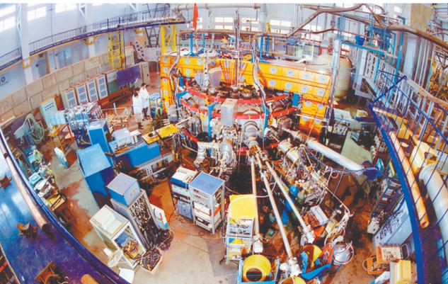
1994年12月，由T-7改造成的超导托卡马克装置HT-7首次获得等离子体，成为中国第一台超导托卡马克。
