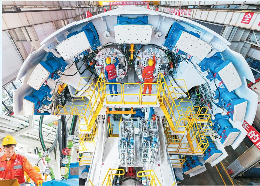
▲在铁建重工长沙第一产业园，工人在调试“永庆号”盾构机。
