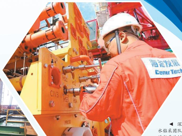
▲ 深水钻采团队进行采油树测试作业。
