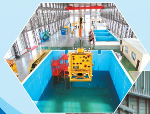
▲ 浅水采油树在水下实验室测试。
