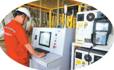
▲甘肃金风电设备制造有限公司数字化车间内，工人正在操控六轴工业机器人进行变桨轴承螺栓自动拉伸作业。银燕、陈燕摄
