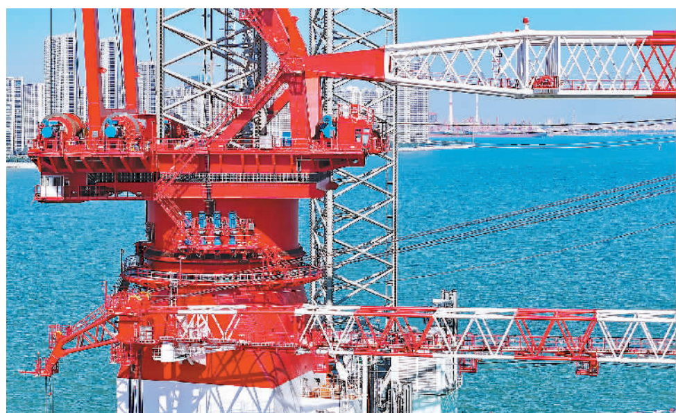
8月28日，国内首艘搭载智能船舶系统的自升式海上风电安装平台“港航平5”在山东省青岛市交付。“港航平5”平台船长135米，宽50米，最大作业水深70米，最大起重能力1800吨，正式投用后预计一年可安装海上风机100台以上。图为交付现场。 张进刚摄（人民视觉）
