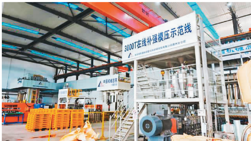
在北京机科国创轻量化科学研究院有限公司德州分公司,3000吨级在线补强模压示范线正在生产大型复合材料部件。新华社记者 萧海川摄
