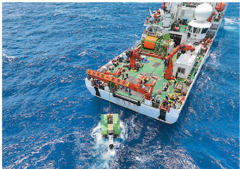
图为深海重载作业采矿车工程样机“开拓二号”海试现场。
