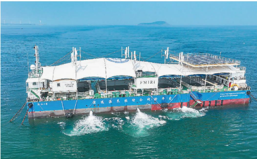
近日，在山东省荣成市北部海域，由中国水产科学研究院渔业机械仪器研究所与荣成市携手打造的“渔帆1号”深远海养殖综合试验平台成功布放并投入运营。这是全国首座集深远海养殖新品种开发、工业化养殖模式研究及试验观测等多功能于一体的封闭式舱养系统综合试验平台，设有4个大型及20个小型封闭式试验舱，养殖水体达5000立方米，能够满足多样化的深远海养殖实验需求。
