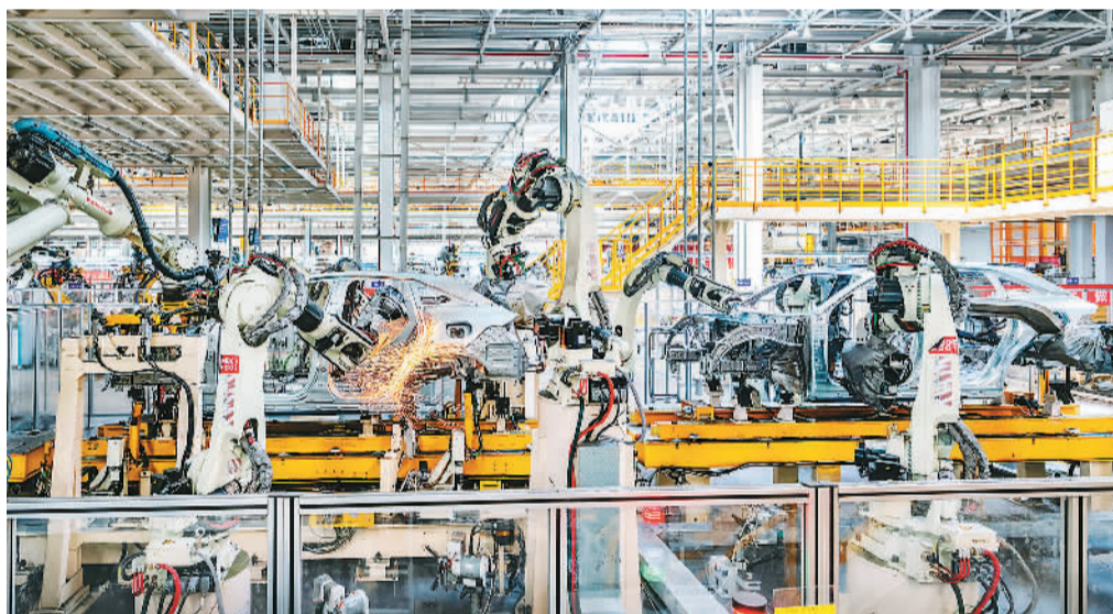
位于江苏省南京市溧水区的南京长安汽车新工厂自动化生产车间内,机械手臂正灵活焊接组装新能源汽车。
