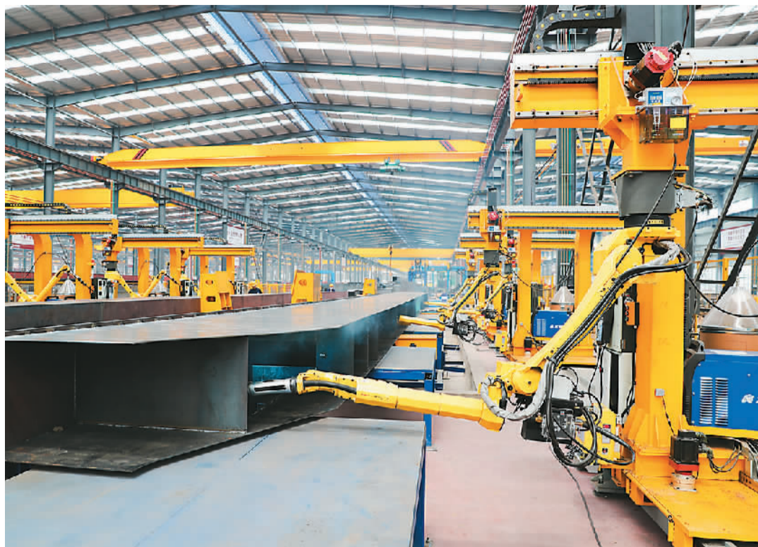
▲河南矿山全自动双梁主梁内缝机器人焊接工作站。
