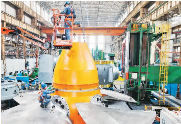
哈电集团哈尔滨电机厂有限责任公司研制的银江水电站2号机转轮日前顺利通过验收。银江水电站单机容量65兆瓦，是亚洲最大的贯流式机组。为了打造银江精品机组，哈电电机技术团队有针对性地进行了关键技术攻关，其稳定性、能量特性达到国际领先水平。
