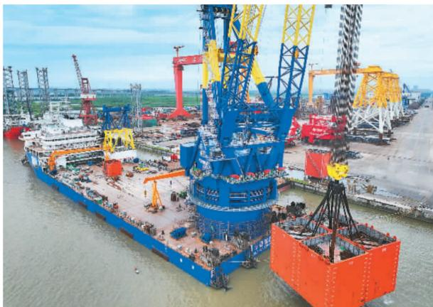
日前，由南通振华重装建造的华夏金租5000吨自航式全回转起重船“华夏鲲鹏01”开始3500吨吊重试验。试验完成后，将进行1.1倍吊重试验。该起重船长195米，型宽49.8米，型深16米，设流线性船艏，可无限航区航行。
